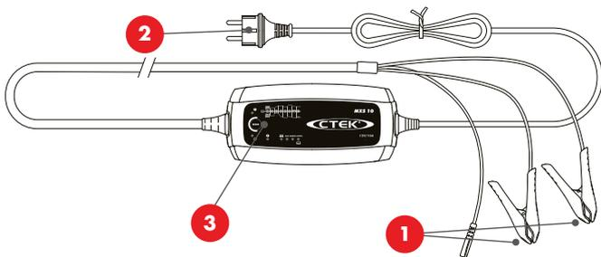
**1. Collegare il caricabatterie alla batteria.****2. Collegare il caricabatterie alla presa a muro.**
